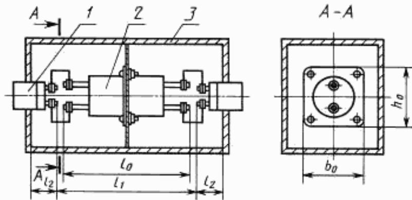
1 — двухпроводный разъем; 2 — измеряемый фильтр;
