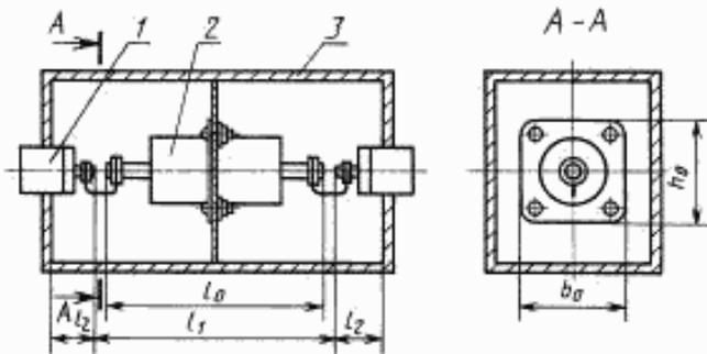
1 — коаксиальный разъем; 2 — измеряемый конденсатор или фильтр; 3 — испытательный контейнер
