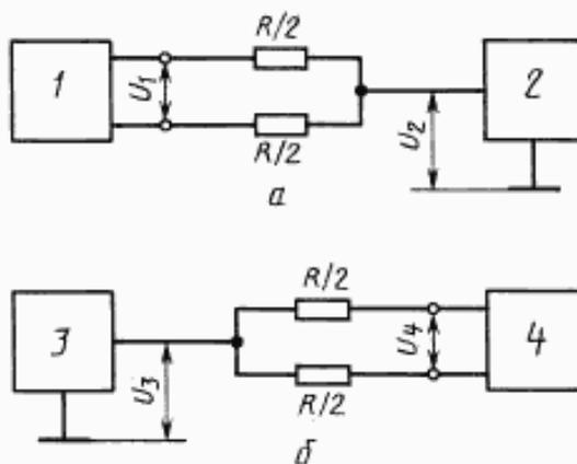
*а* — проверка коэффициента симметрии генератора;
