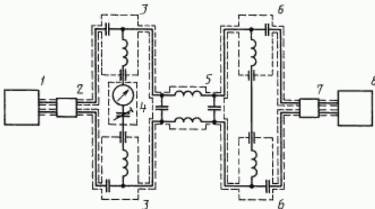
1 — генератор сигналов; 2 — развязывающий аттенуатор 10 дБ; 3 — разделительное устройство; 4 — источник тока; 5 — измеряемый фильтр; 6 — разделительное устройство; 7 — развязывающий аттенуатор 10 дБ; 8 — измерительный приемник
