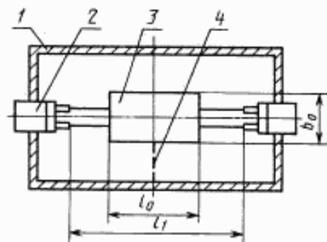
1 — испытательный контейнер; 2 — двухпроводный разъем; 3 — измеряемый конденсатор или фильтр;
