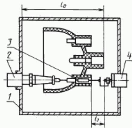
1 – испытательный контейнер; 2 – переходная втулка; 3 – измеряемый элемент; 4 – коаксиальный разъем
