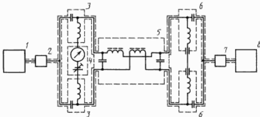
1 — генератор сигналов; 2 — развязывающий аттенуатор 10 дБ; 3 — разделительное устройство; 4 — источник тока; 5 — измеряемый фильтр; 6 — разделительное устройство; 7 — развязывающий аттенуатор 10 дБ; 8 — измерительный приемник
