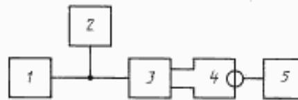
1 — генератор сигналов; 2 — вольтметр с высоким полным сопротивлением;
