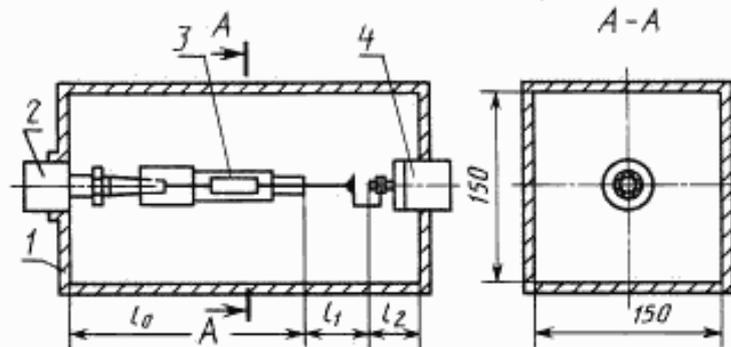
1 — испытательный контейнер; 2 — переходная втулка; 3 — измеряемый элемент; 4 — коаксиальный разъем
