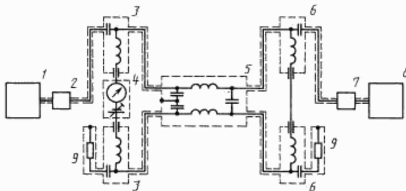
1 — генератор сигналов; 2 — развязывающий аттенуатор 10 дБ; 3 — разделительное устройство; 4 — источник тока; 5 — измеряемый фильтр; 6 — разделительное устройство; 7 — развязывающий аттенуатор 10 дБ; 8 — измерительный приемник; 9 — активное сопротивление, равное волновому сопротивлению измерительной схемы
