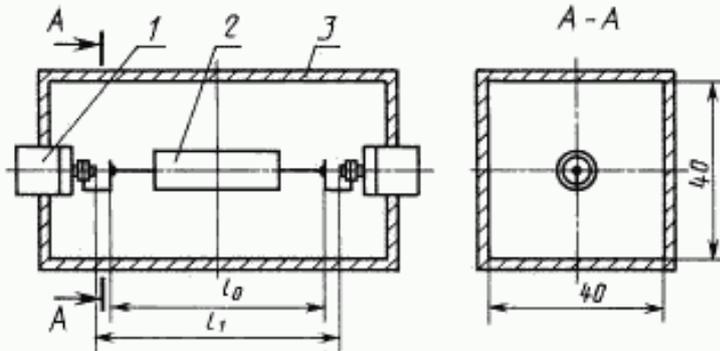
1 — коаксиальный разъем; 2 — измеримый дроссель; 3 — испытательный контейнер;
