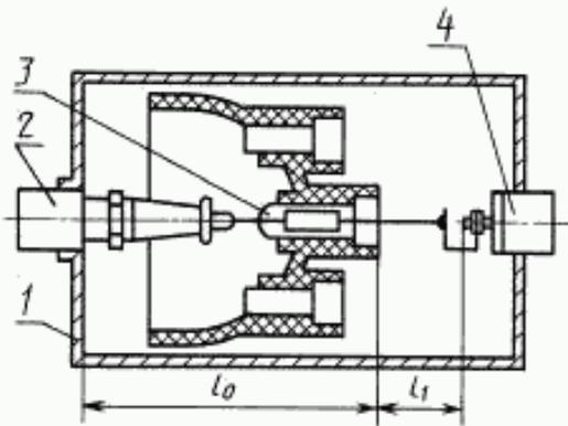
1 – испытательный контейнер; 2 – переходная втулка; 3 – измеряемый элемент; 4 – коаксиальный разъем
