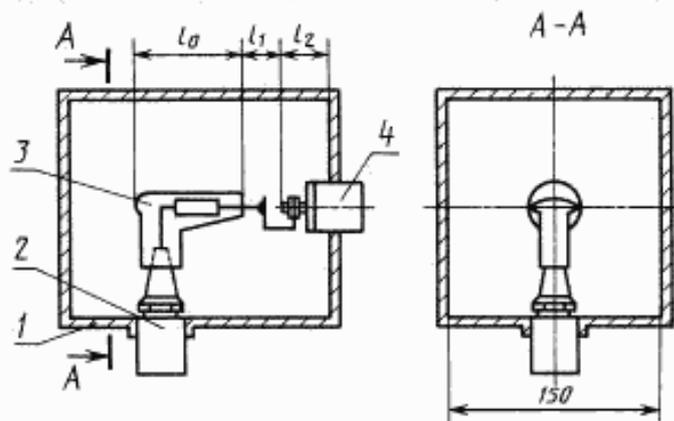
1 — испытательный контейнер; 2 — переходная втулка; 3 — измеряемый элемент; 4 — коаксиальный разъем
