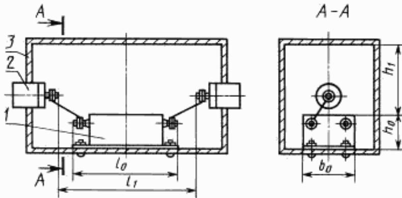
1 — измеряемый конденсатор или фильтр; 2 — коаксиальный разъем; 3 — испытательный контейнер
