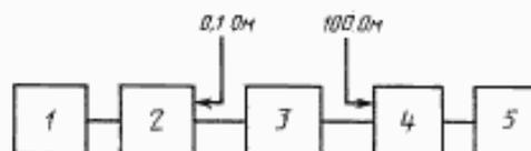
1 — генератор с сопротивлением 50 Ом; 2 — трансформатор с коэффициентом трансформации 22:1;
