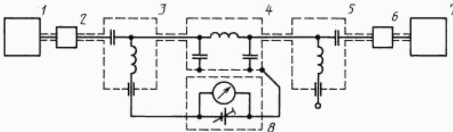
1 — генератор сигналов; 2 — развязывающий аттенуатор 10 дБ; 3 — разделительное устройство; 4 — измеряемый фильтр; 5 — разделительное устройство; 6 — развязывающий аттенуатор 10 дБ; 7 — измерительный приемник; 8 — источник напряжения
