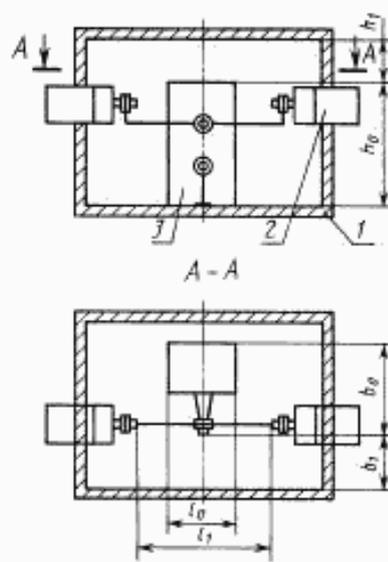
1 — испытательный контейнер; 2 — коаксиальный разъем; 3 — измеряемый конденсатор
