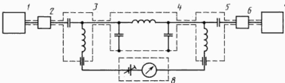
1 — генератор сигналов; 2 — развязывающий аттенуатор 10 дБ; 3 — разделительное устройство; 4 — испытываемый
