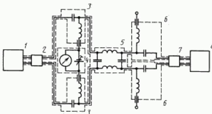
1 — генератор сигналов; 2 — развязывающий аттенуатор 10 дБ; 3 — разделительное устройство; 4 — источник напряжения; 5 — измеряемый фильтр; 6 — разделительное устройство; 7 — развязывающий аттенуатор 10 дБ; 8 — измерительный приемник
