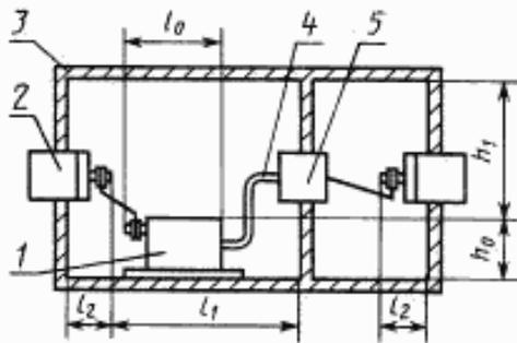
1 — измеряемый фильтр; 2 — коаксиальный разъем;
