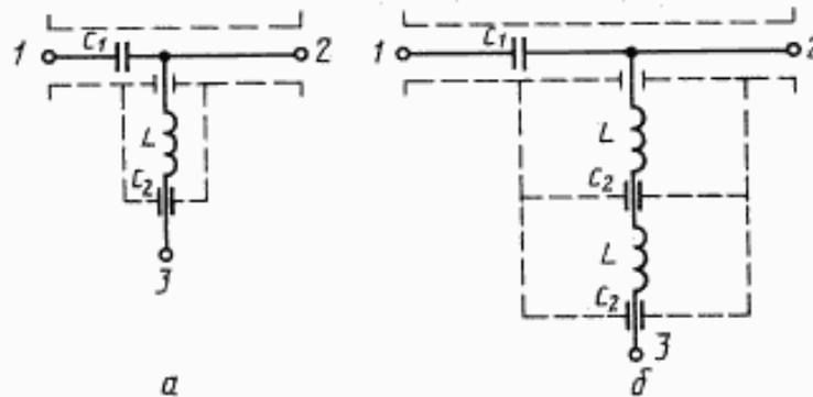
*a* — на полосу частот 0,1–30 МГц; *b* — на полосу частот 30–300 МГц;
