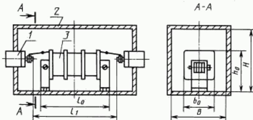
1 – коаксиальный разъем; 2 – испытательный контейнер; 3 – измеряемый дроссель;  $b = 3 b_0$ ;  $H = 2 h_0$ ;  $l_0$  – длина дросселя;  $l_1$  – расстояние между клеммами разъема
