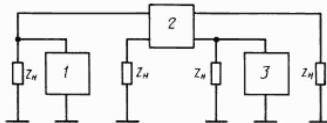
$I$  — генератор сигналов;  $2$  — многопроводный фильтр;  $J$  — измерительный приемник
