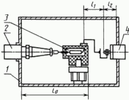
1 – испытательный контейнер; 2 – переходная втулка; 3 – измеряемый элемент; 4 – коаксиальный разъем
