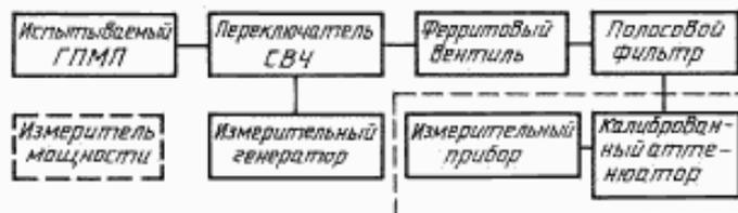
Рисунок В.1 — Структурная схема измерения относительного уровня побочных колебаний ГППП методом замещения
