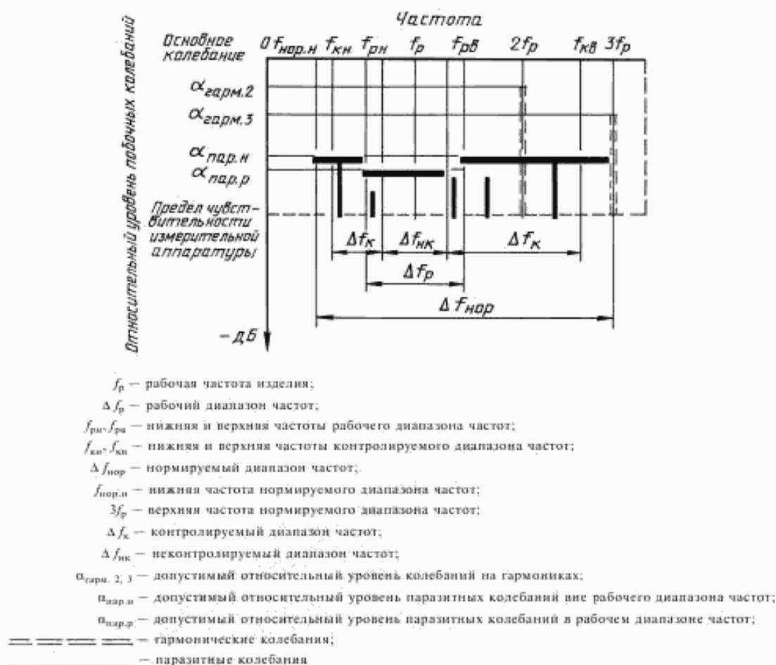
Рисунок 1 — Характерные значения частот, диапазонов частот, уровней колебаний на гармониках и паразитных колебаний
