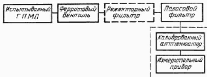
Рисунок Б.1 — Структурная схема измерений мощности побочных колебаний
