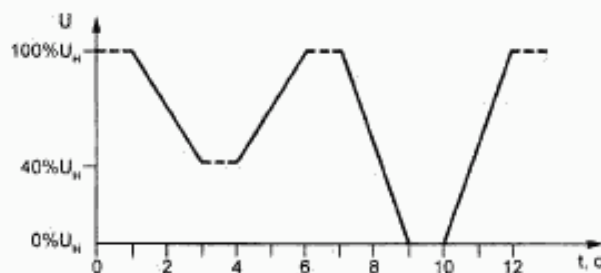
Рисунок 1 — Динамические изменения напряжения (провалы)
