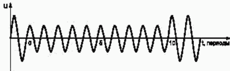
Рисунок 1 — Динамические изменения напряжения (провалы)
