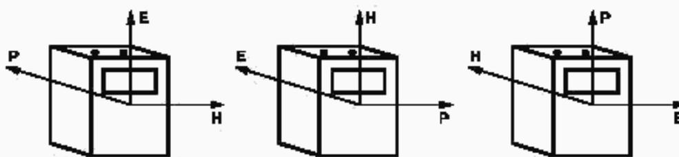
Е — вектор электрического поля; Н — вектор магнитного поля; Р — направление распространения электромагнитного поля.
