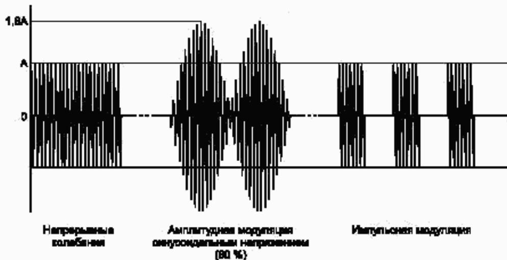
A — амплитуда модулирующего напряжения
