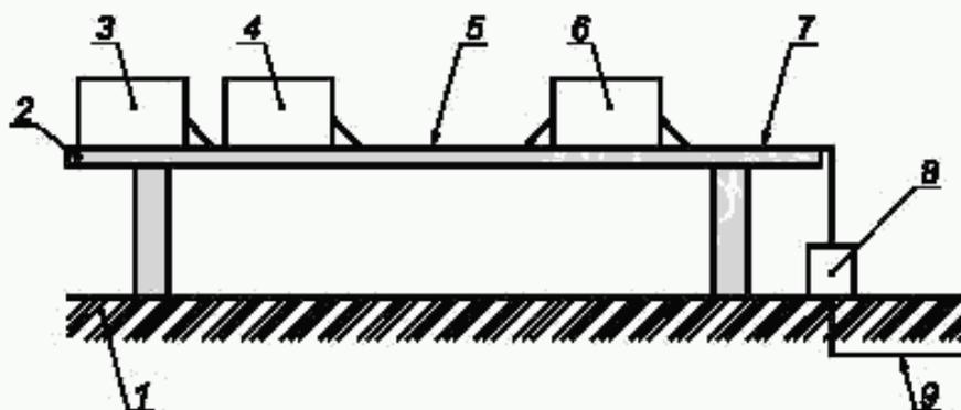
1 — металлический пол безэховой камеры; 2 — непроводящая поверхность (деревянный стол); 3 — блок связи; 4 — дополнительная нагрузка; 5 — кабель шины; 6 — испытуемый блок питания; 7 — кабель электропитания; 8 — развязывающий фильтр; 9 — подключение к сети электропитания
