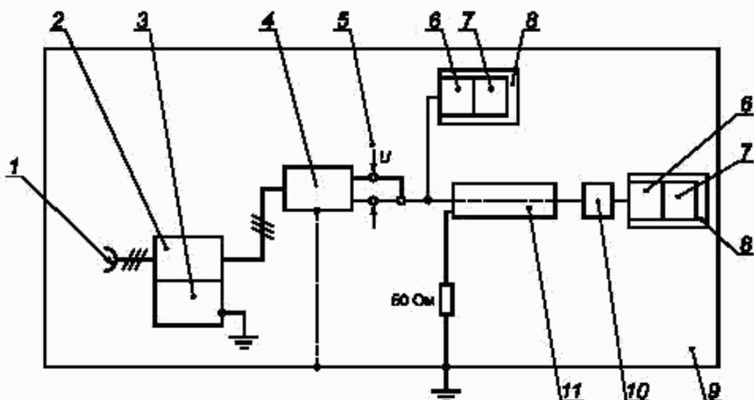
1 — сеть электропитания переменного тока 220 В, 50 Гц; 2 — устройство связи / развязки; 3 — испытательный генератор НИП; 4 — испытуемый блок питания; 5 — напряжение на выходе блока питания, подаваемое в шину; 6 — фильтр; 7 — передатчик / приемник; 8 — блок связи; 9 — пластина заземления; 10 — аттенуатор; 11 — емкостные клещи связи
