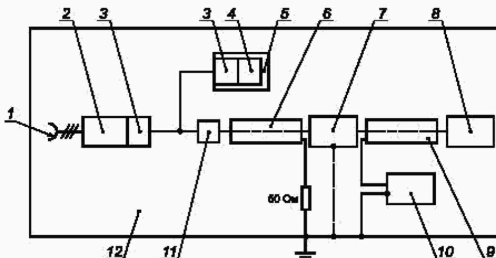
1 — сеть электропитания переменного тока 220 В, 50 Гц; 2 — блок питания; 3 — фильтр; 4 — передатчик / приемник; 5 — блок связи; 6 — емкостные клещи связи; 7 — испытуемый блок; 8 — устройство контроля функционирования испытуемого блока; 9 — емкостные клещи связи; 10 — испытательный генератор НИП; 11 — аттенуатор; 12 — пластина заземления
