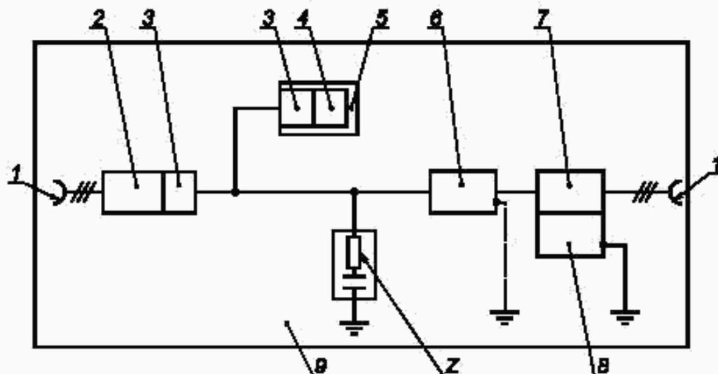
1 — сеть электропитания переменного тока 220 В, 50 Гц; 2 — блок питания; 3 — фильтр; 4 — передатчик / приемник; 5 — блок связи; 6 — испытуемый блок; 7 — устройство связи / развязки; 8 — испытательный генератор МИП; 9 — непроводящая поверхность
