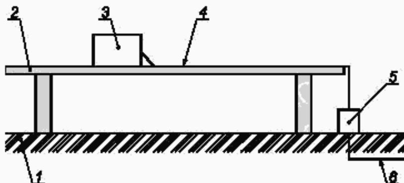
1 — металлический пол беззвонной камеры; 2 — непроводящая поверхность (деревянный стол высотой 0,8 — 1 м); 3 — испытываемый блок; 4 — кабель шины; 5 — развязывающий фильтр; 6 — соединения кабеля шины с блоком связи и измерительной аппаратурой
