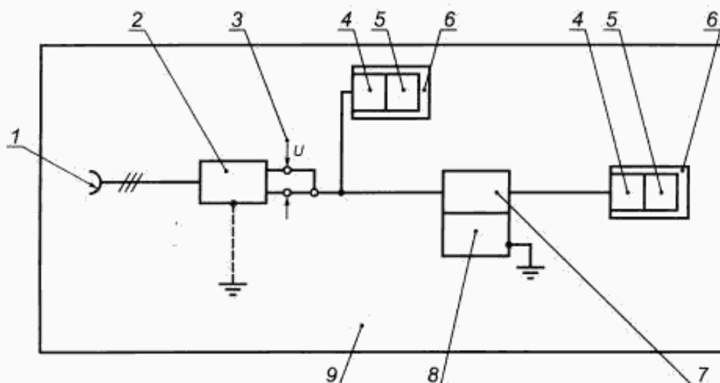
1 — сеть электропитания переменного тока 220 В, 50 Гц; 2 — испытуемый блок питания; 3 — напряжение на выходе блока питания, подаваемое в шину; 4 — фильтр; 5 — передатчик / приемник; 6 — блок связи; 7 — устройство связи / развязки; 8 — испытательный генератор МИП; 9 — непроводящая поверхность
