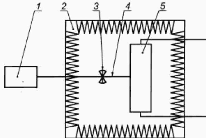
1 — измерительная аппаратура; 2 — беззвонная камера; 3 — измерительная антенна; 4 — измерительное расстояние; 5 — место размещения испытываемых устройств
