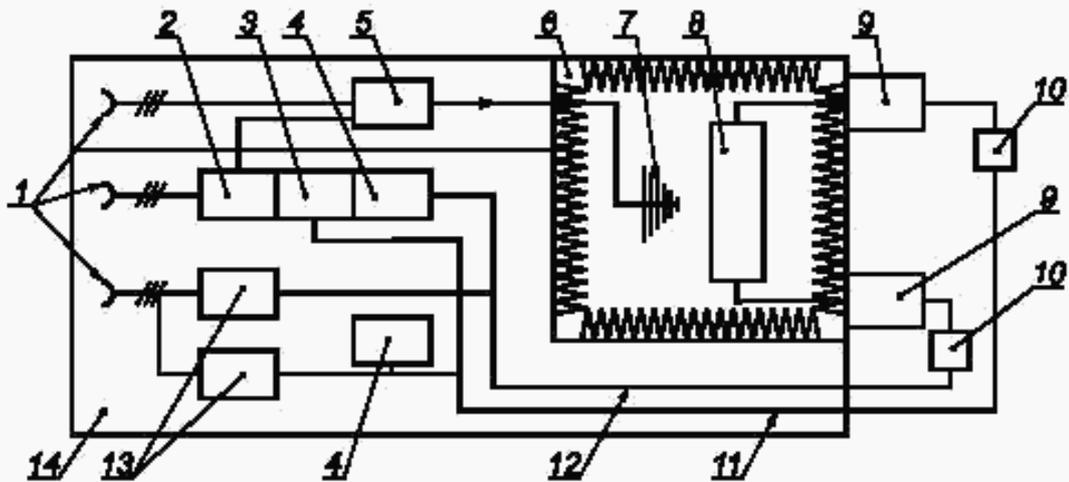
1 — сеть электропитания переменного тока 220 В, 50 Гц; 2 — измерительная аппаратура; 3 — оборудование для управления и оценки; 4 — блок связи (передатчик / приемник); 5 — генератор сигналов высокой частоты и усилитель; 6 — безэховая камера; 7 — излучающая антенна; 8 — место размещения испытуемых устройств; 9 — проходной фильтр; 10 — аттенюатор; 11 — кабель ввода-вывода сигналов; 12 — кабель шины; 13 — блок питания; 14 — помещение для измерительной аппаратуры
