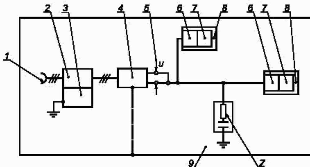
1 — сеть электропитания переменного тока 220 В, 50 Гц; 2 — устройство связи / развязки; 3 — испытательный генератор МИП; 4 — испытуемый блок питания; 5 — напряжение на выходе блока питания, подаваемое в шину; 6 — фильтр; 7 — передатчик / приемник; 8 — блок связи; 9 — непроводящая поверхность (например, деревянный стол)
