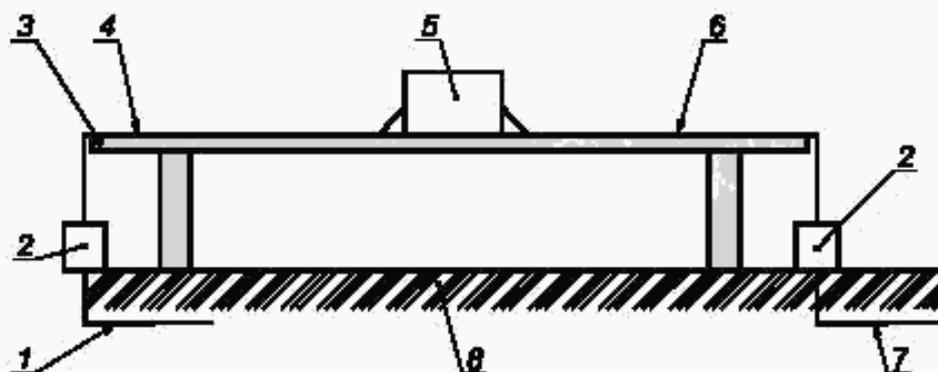
1 — соединения кабеля шины с блоком связи и измерительной аппаратурой; 2 — развязывающий фильтр; 3 — непроводящая поверхность (деревянный стол); 4 — кабель шины; 5 — испытуемый блок питания; 6 — кабель электропитания; 7 — подключение к сети электропитания; 8 — пол безэховой камеры
