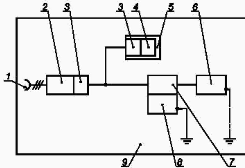
1 — сеть электропитания переменного тока 220 В, 50 Гц; 2 — блок питания; 3 — фильтр; 4 — передатчик / приемник; 5 — блок связи; 6 — испытуемое устройство; 7 — устройство связи / разъезки; 8 — испытательный генератор МИП; 9 — непроводящая поверхность
