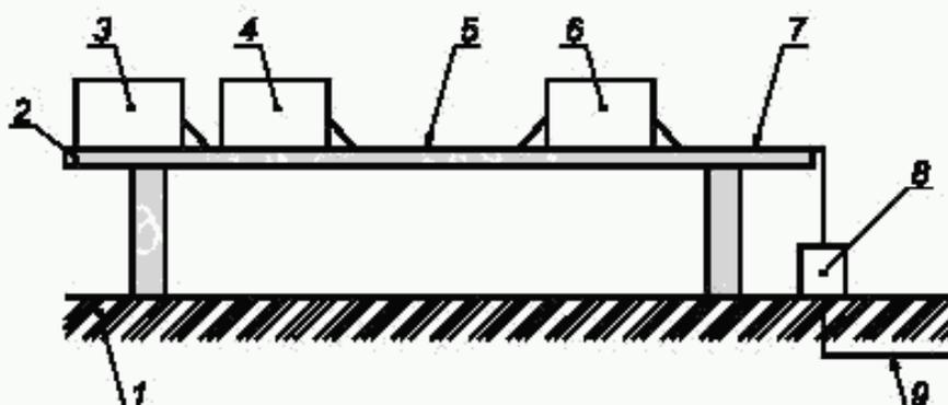
1 — металлический пол безэховой камеры; 2 — непроводящая поверхность (деревянный стол); 3 — испытуемое устройство; 4 — блок связи; 5 — кабель шины; 6 — блок питания; 7 — кабель электропитания; 8 — развязывающий фильтр; 9 — подключение к сети электропитания
