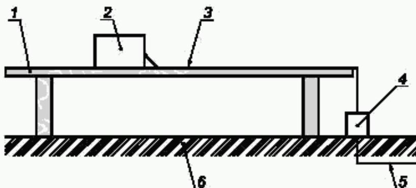
1 — непроводящая поверхность (деревянный стол высотой 0,8 — 1 м); 2 — испытуемый блок; 3 — кабель шины; 4 — развязывающий фильтр; 5 — соединения кабеля шины с блоком связи и измерительной аппаратурой; 6 — пол безэховой камеры
