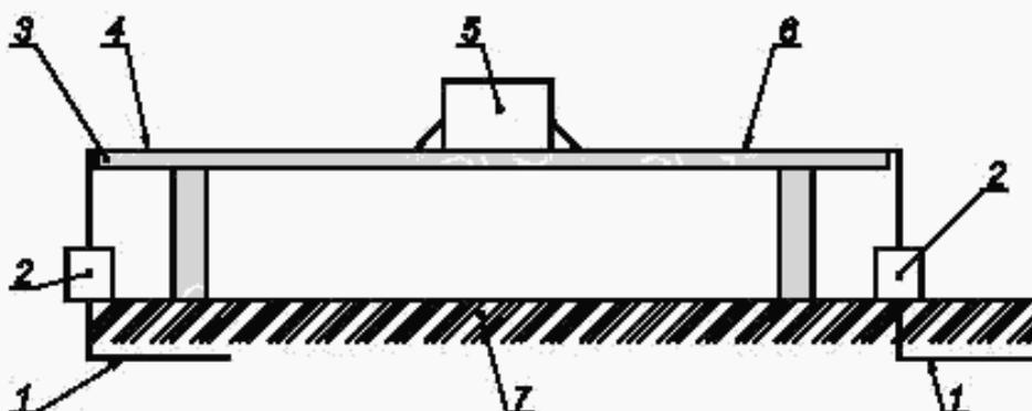
1 — соединения кабеля шины или ввода-вывода сигналов с блоком связи, внешним устройством или измерительной аппаратурой; 2 — развязывающий фильтр; 3 — непроводящая поверхность (деревянный стол); 4 — кабель шины; 5 — испытуемое устройство; 6 — кабель ввода-вывода сигналов; 7 — пол безэховой камеры
