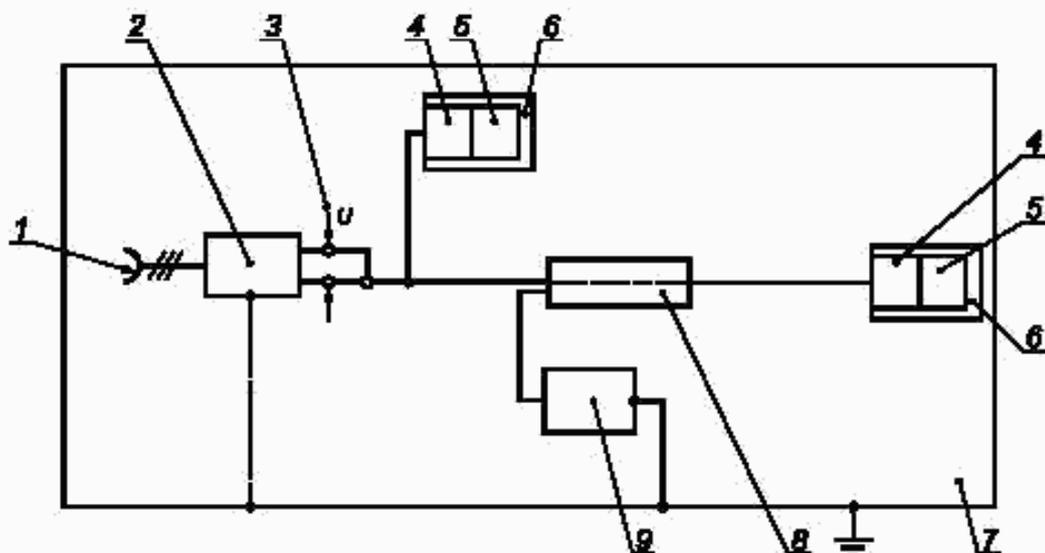
1 — сеть электропитания переменного тока 220 В, 50 Гц; 2 — испытуемый блок питания; 3 — напряжение на выходе блока питания, подаваемое в шину; 4 — фильтр; 5 — передатчик / приемник; 6 — блок связи; 7 — пластина заземления; 8 — емкостные клещи связи; 9 — испытательный генератор НИП
