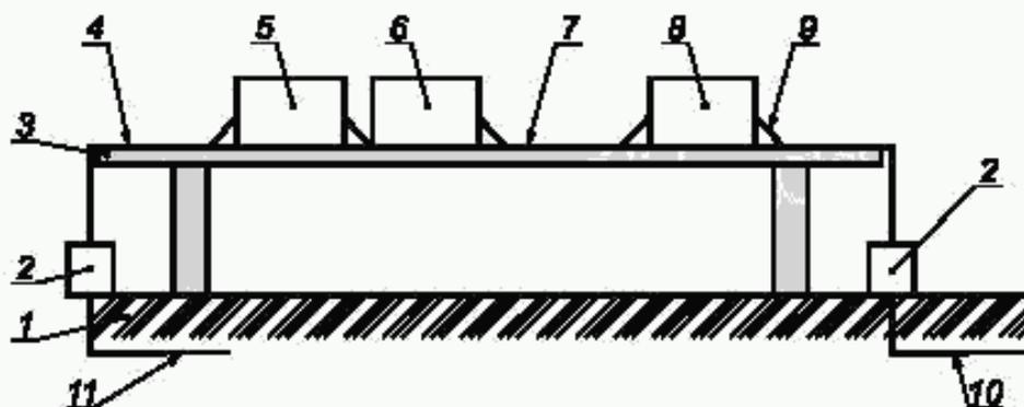
1 — металлический пол безэховой камеры; 2 — развязывающий фильтр; 3 — непроводящая поверхность (деревянный стол); 4 — кабель ввода-вывода сигналов; 5 — испытуемое устройство; 6 — блок связи; 7 — кабель шины; 8 — блок питания; 9 — кабель электропитания; 10 — подключение к сети электропитания; 11 — соединения кабеля ввода-вывода сигналов с внешним устройством
